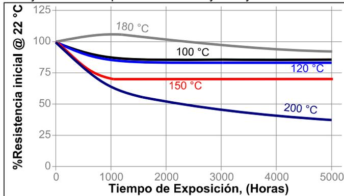
**Envejecimiento con Temperatura/ Resistencia al calor**
